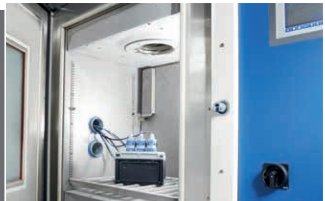
Langzeittest bei -40 C° im Klimaschrank
