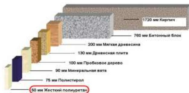
Рисунок 1 Теплопроводность пенополиуретана
