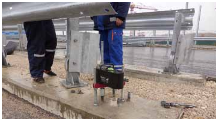
Испытание несущей способности анкерной группы крепления барьерного ограждения (расчетная несущая способность 35,7 кН)
