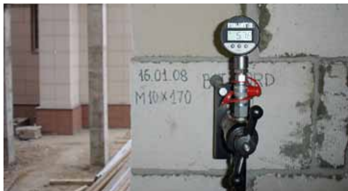
Испытания BIT-NORD в кладке из ячеисто-бетонных блоков (резьбовая шпилька М10, глубина заделки L=170 мм, максимальная нагрузка 5,78 кН)
