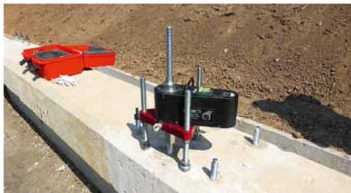
Испытание анкерных элементов креплений стоек шумозащитных экранов (анкер-шпилька ВІТ-SS M24 × 300, расчетная нагрузка на вырыв 82,9 кН)
