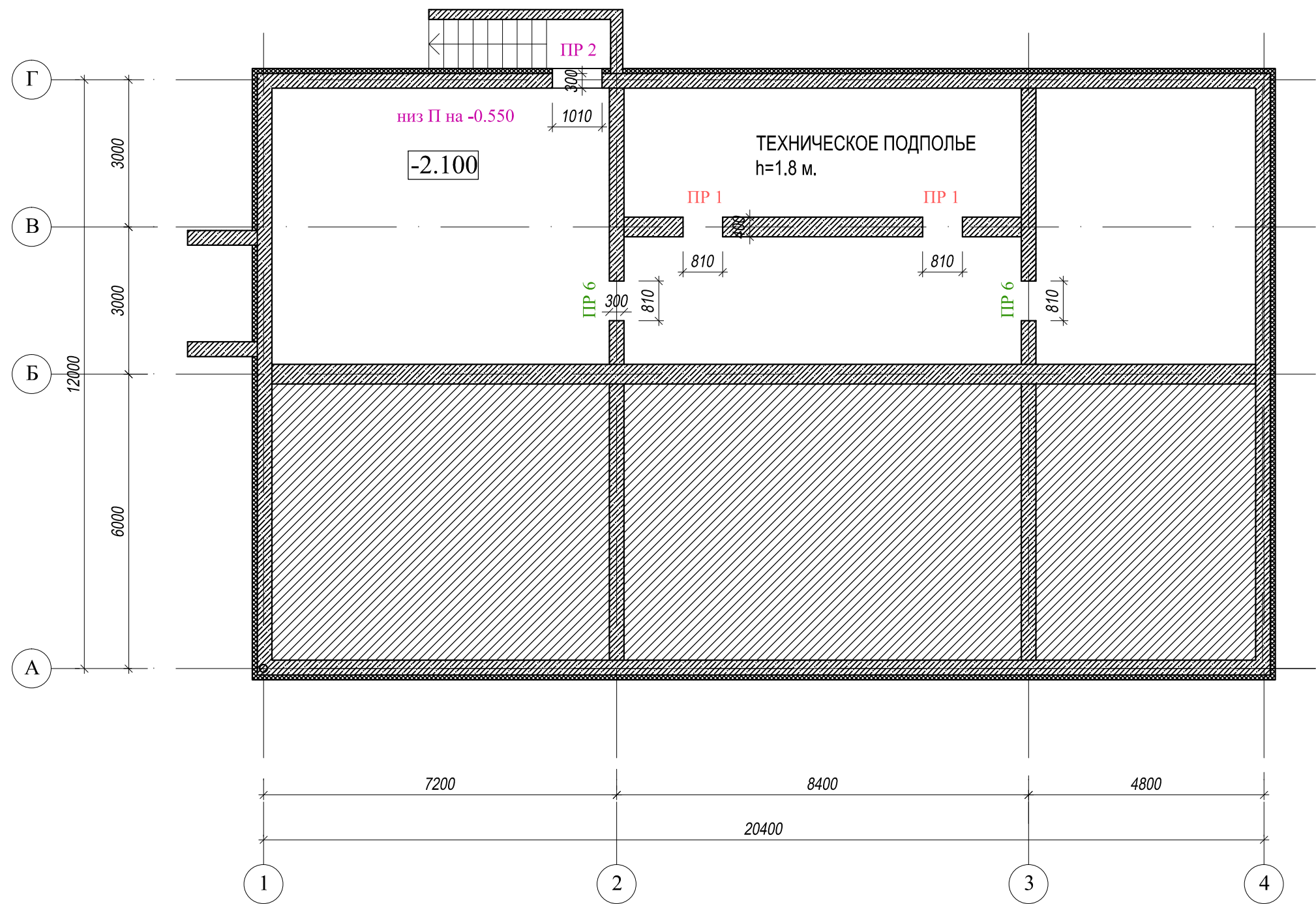
Схема расположения перемычек на отм. -2.100.
