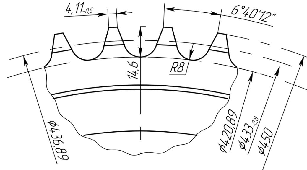
1. Термообработка зубчатого венца HRC 45...50
