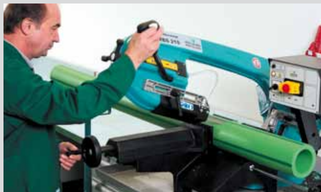
Перед сваркой отрезать трубу на необходимую длину
