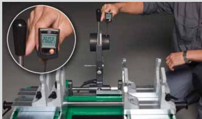
Измерение температуры на сварочной машине aquatherm
