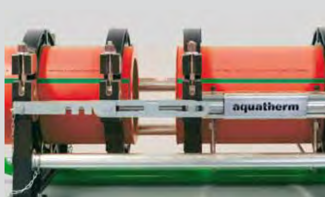
Трубы развести, удалить нагревательный элемент
