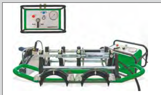
Проверить функции сварочного аппарата и нагреть его
