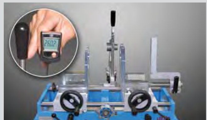
Измерение темп. на сварочном аппарате aquatherm
