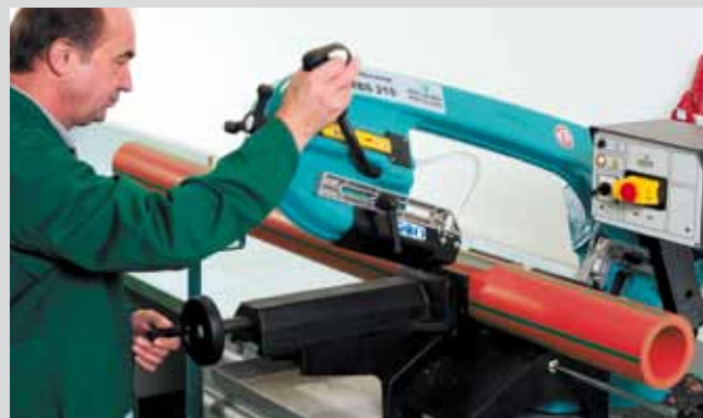
Перед сваркой отрезать трубу на необходимую длину
