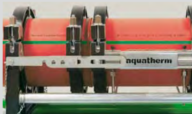
Трубы свести, под давлением дать соединению остыть
