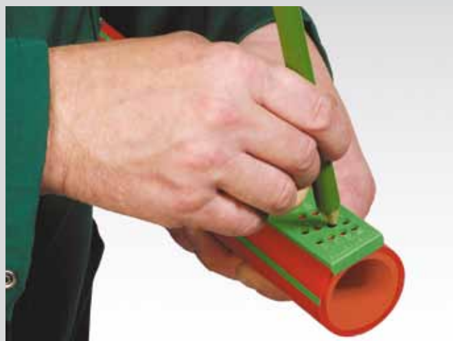
Отметка глубины сварки
