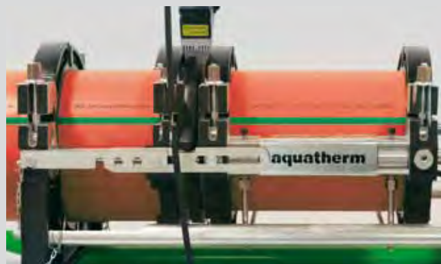
Вставка сварочного элемента
