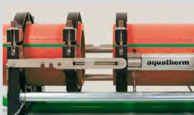
Свариваемые части вставить, выровнять и зафиксировать
