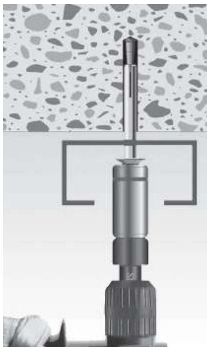
Забить монтажный анкер МРС.
