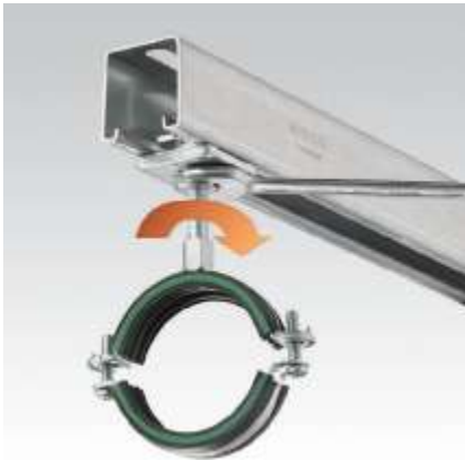
Ввинтить шпильку в MPR-Быстрый зажим и законтрить гайкой. Смонтировать хомут.
