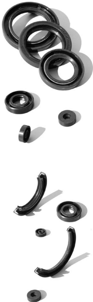
Манжеты с пружиной для уплотнения валов, работающие в минеральных маслах, воде, дизельном топливе при избыточном давлении до 0,05 МПа (0,5 кгс/см<sup>2</sup>), скорости до 20 м/с и температуре от минус 60°С до плюс 170°С в зависимости от группы резины.
