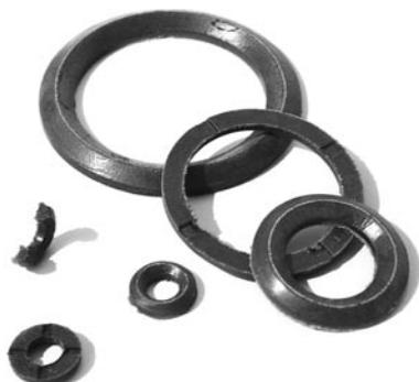
Шевронные резинотканевые уплотнения для штоков и цилиндров гидравлических устройств диаметром до 2000 мм, работающих при давлении до 63 МПа со скоростью возвратно-поступательного движения до 3 м/с в среде минеральных масел, нефти, пресной и морской воды, водных эмульсий при температуре от минус 50°С до плюс 100°С (кратковременно до 120°С).
