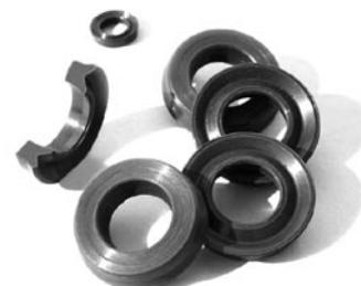
Резиновые манжеты предназначены для уплотнения зазора между цилиндром и поршнем (плунжером, штоком) в гидравлических устройствах, работающих в условиях возвратно-поступательного движения со скоростью относительного перемещения не более 0,5 м/с, при давлении до 50 МПа, температуре от минус 60°C до плюс 200°C, ходе до 10 м и частоте срабатывания до 0,5 Гц.
