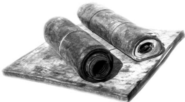
Технические пластины предназначены для изготовления резинотехнических изделий, служащих для уплотнения неподвижных соединений, предотвращения трения между металлическими поверхностями, для восприятия одиночных ударных нагрузок, а также в качестве прокладок, настилов и других уплотнительных соединений.
