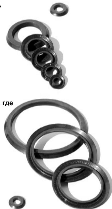
Резиновые манжеты для уплотнения цилиндров и штоков пневматических устройств, работающих при давлении от 0,005 до 1 МПа (от 0,05 до 10 кгс/см<sup>2</sup>) со скоростью возвратно-поступательного движения до 1 м/с и температуре от минус 65°С до плюс 150°С.
