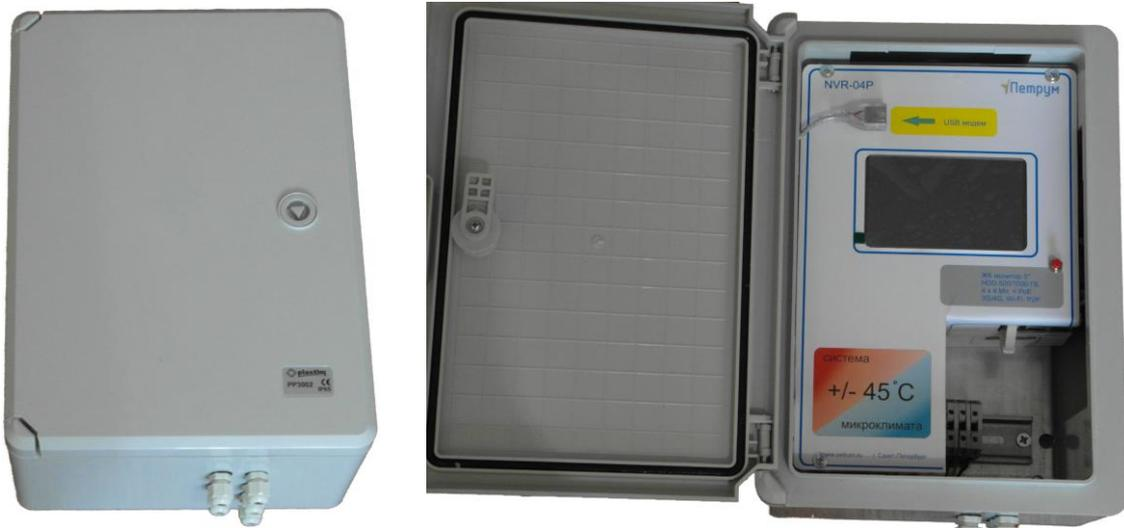
Цифровой IP видеорегистратор (NVR), в промышленном исполнении. Температура эксплуатации от -45 до +45 °С, степень защиты IP-65. Новая модель видеорегистратора имеет встроенный ЖК монитор для просмотра, управления и осуществления необходимых настроек видеорегистратора на объекте.
