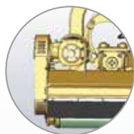
Редуктор с внутренней стороны, расположен максимально близко к трактору (удобно при работе в плотную к деревьям)
