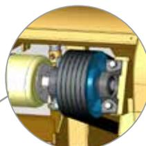
Ременный привод с пружинным натяжителем
