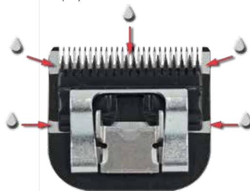
После нанесения масла машинку нужно включить и дать ей поработать немного для равномерного распределения масла по трущимся частям ножей. Снова выключите машинку и протрите снаружи сухой салфеткой, удаляя излишки масла.
