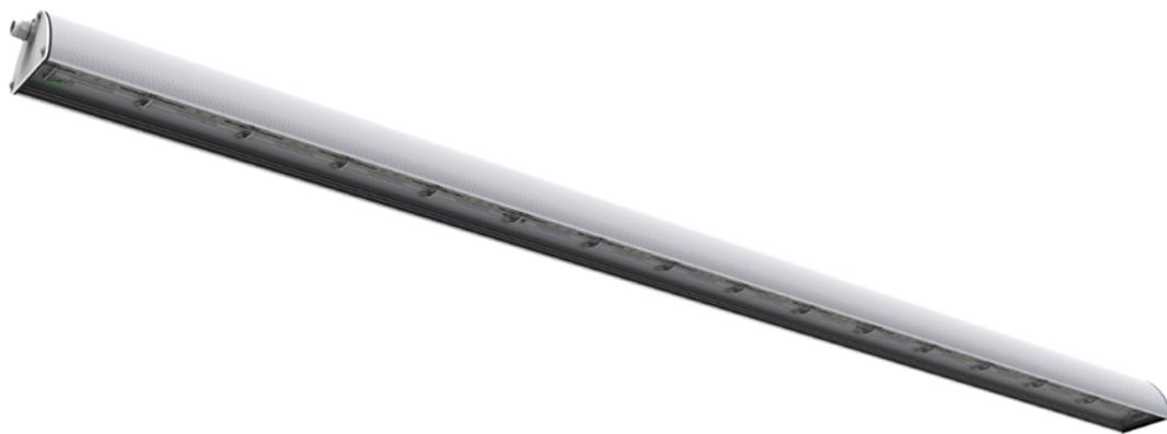
Назначение светильника MBL-L2- помещения, где имеется необходимость выстраивать светильники в непрерывные световые линии. Светильник выпускается в двух исполнениях - концевом и проходном. Внутри проходного светильника проложен пятижильный магистральный провод. Типы монтажа: подвесной, накладной на шпильку, на лоток.
