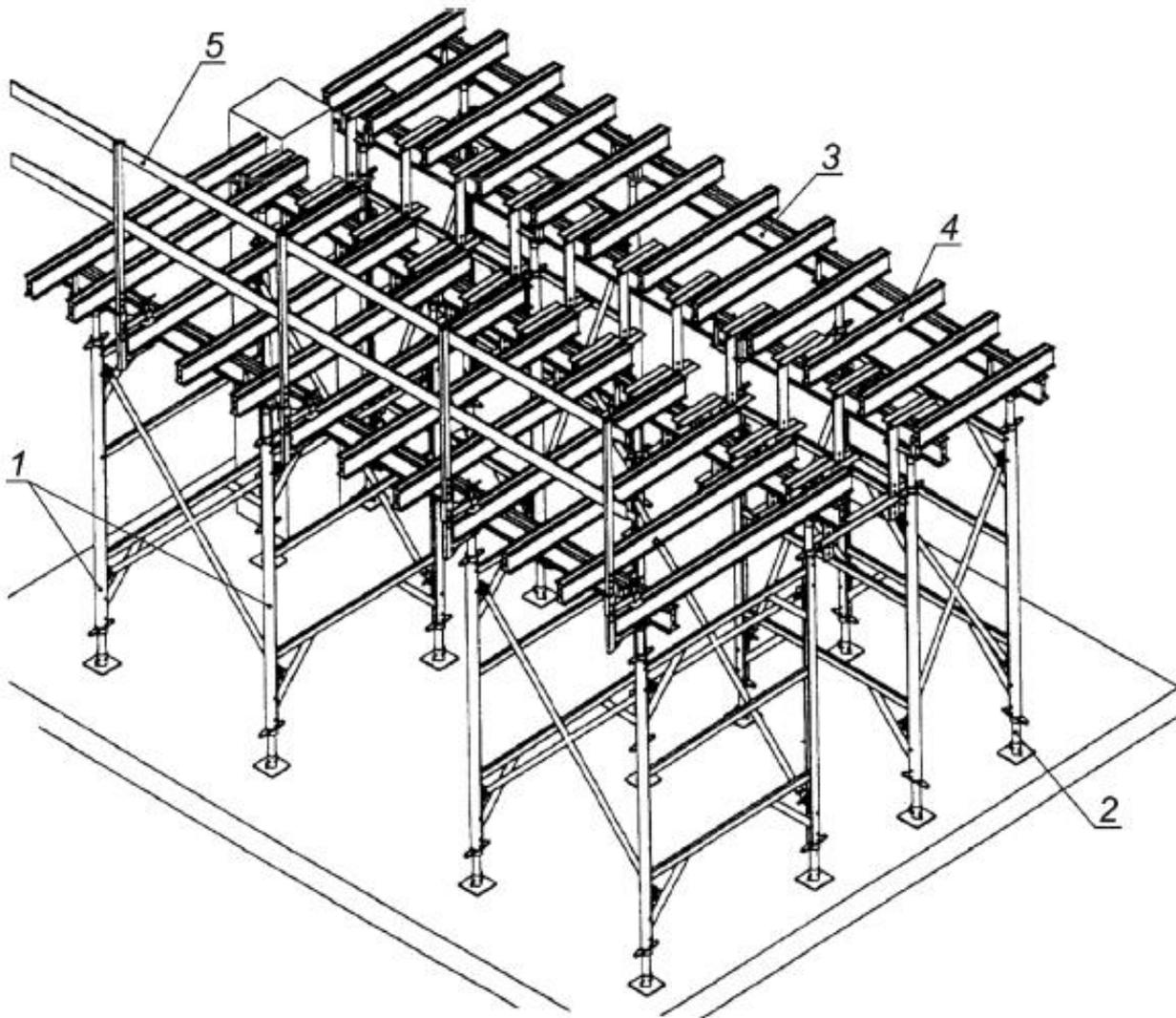
1 - рамы; 2 - домкрат; 3 - продольные балки; 4 - поперечные балки; 5 - ограждение
