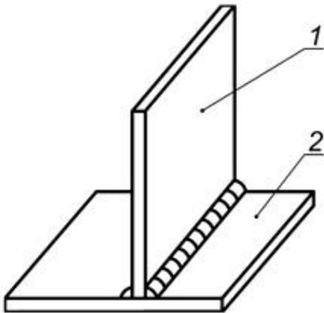
1 - поперечные элементы; 2 - элементы без стыка
