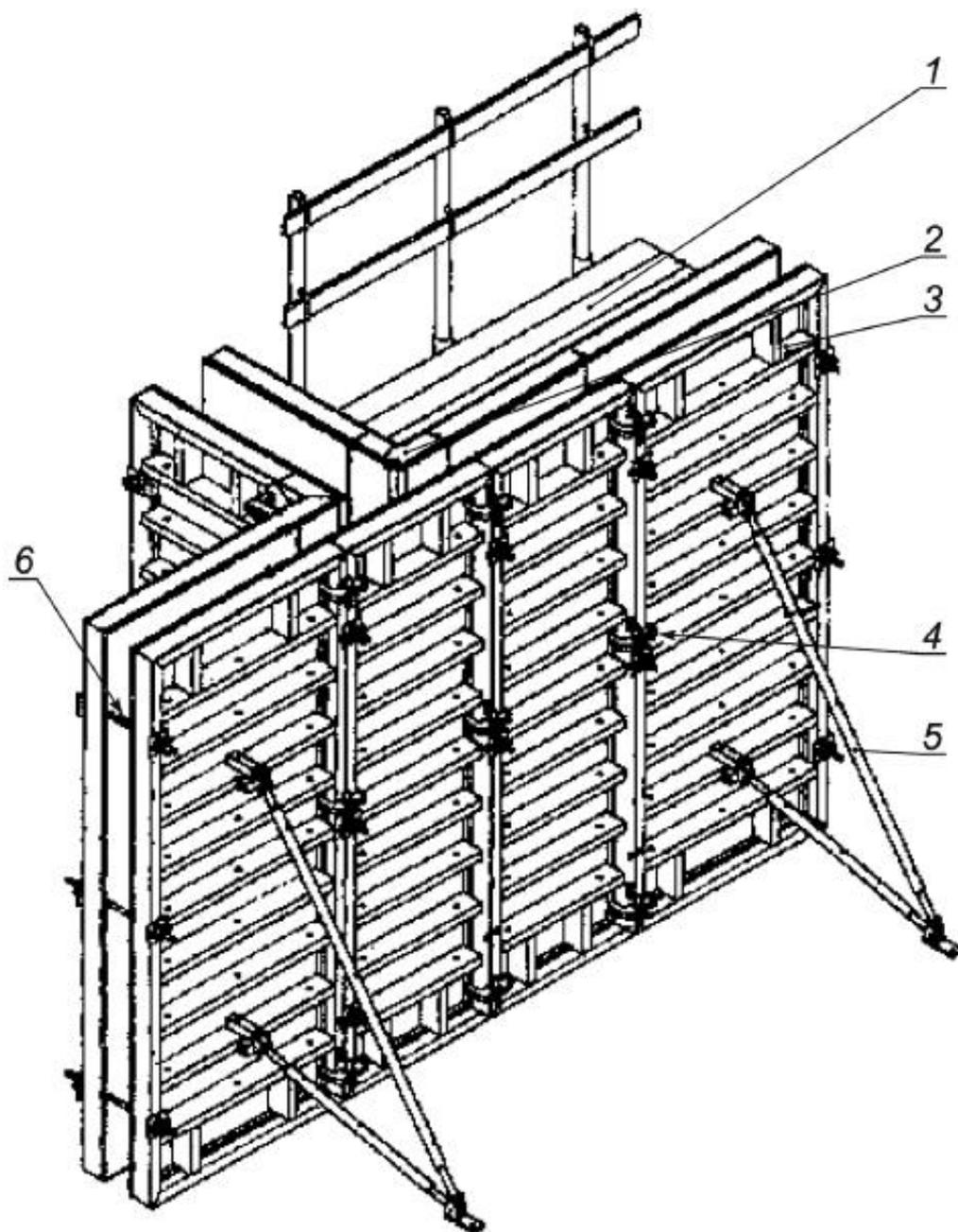
1 - подмости; 2 - угловой щит; 3 - модульные щиты; 4 - замки соединения щитов; 5 - подкос; 6 - стяжка
