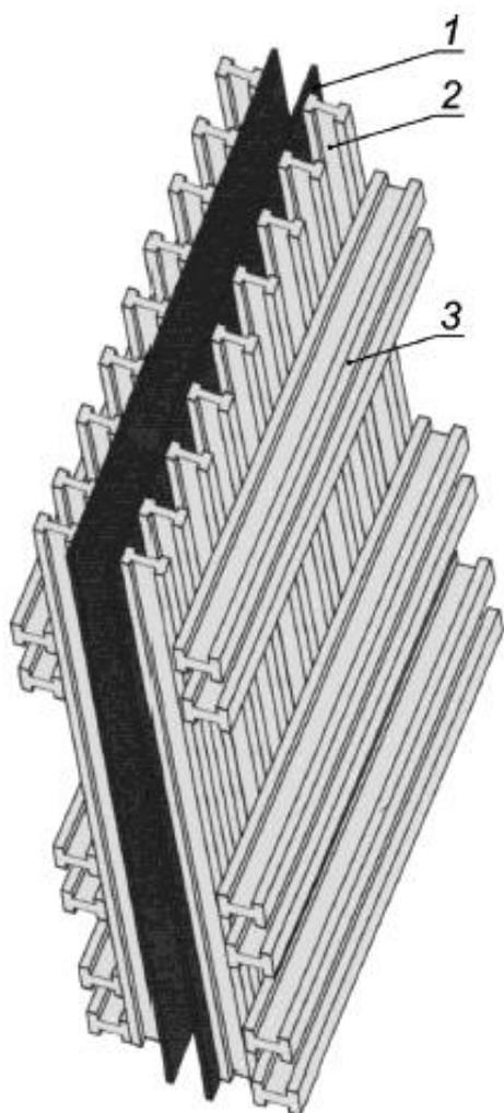
1 - фанера; 2 - вертикальная балка; 3 - сдвоенные балки
