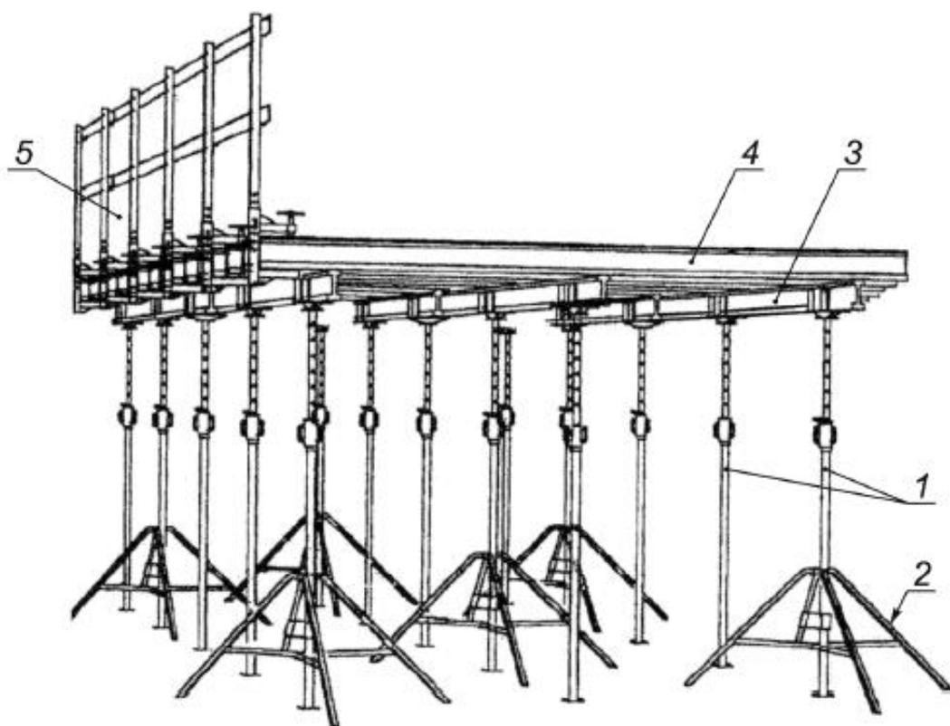
1 - телескопические стойки; 2 - тренога; 3 - продольные балки; 4 - поперечные балки; 5 - ограждение
