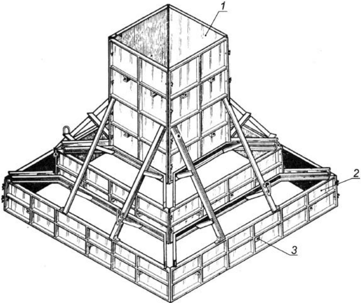
1 - опалубка подколонника; 2 - опалубка ступеней; 3 - отжимное устройство
