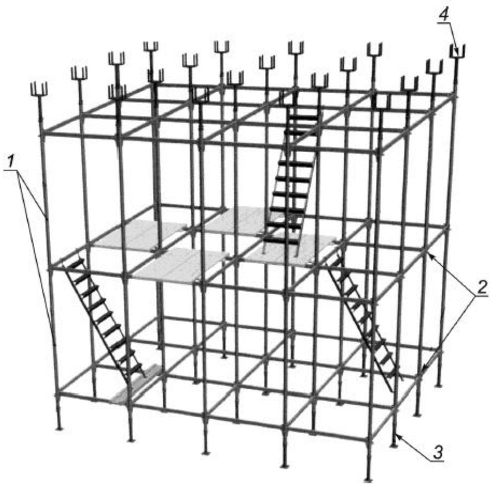
1 - стойки; 2 - шарнирное соединение; 3 - домкрат; 4 - вилки балок
