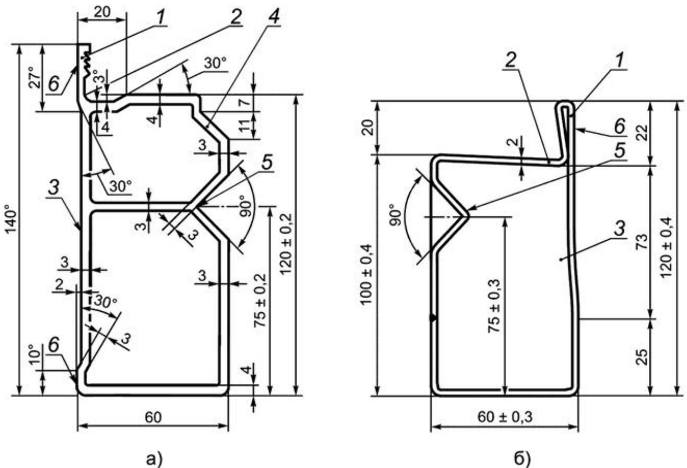
1 - ребро защиты торца фанеры; 2 - карман для герметика и удобства установки фанеры; 3 - запас для уменьшения площади соприкосновения при стыковке щитов; 4 - опора установки второго замка; 5 - опора установки центрирующего замка соединения щитов; 6 - опорные площадки стыковки щитов
