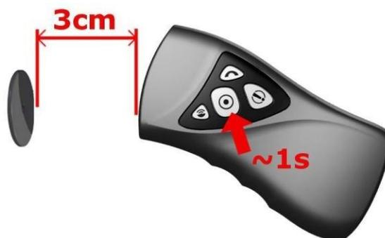
Если включена опция считывания нескольких RFID-меток за один сеанс, процедура следующая: после нажатия кнопки «Считывание» первая метка должна быть прочитана через 15 секунд. Следующие теги необходимо прочитать не позднее, чем указано в параметре RFID. Эти шаги можно повторять до последнего считывания RFID.
