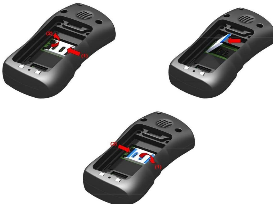
3. Вставьте аккумулятор. Подключите разъем аккумулятора к розетке в аккумуляторном отсеке. Форма разъема предотвращает неправильную установку аккумулятора – в случае проблем с установкой переверните аккумулятор и попробуйте еще раз.
