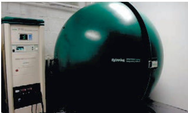
Спектрорадиометр и интегрирующая сфера
