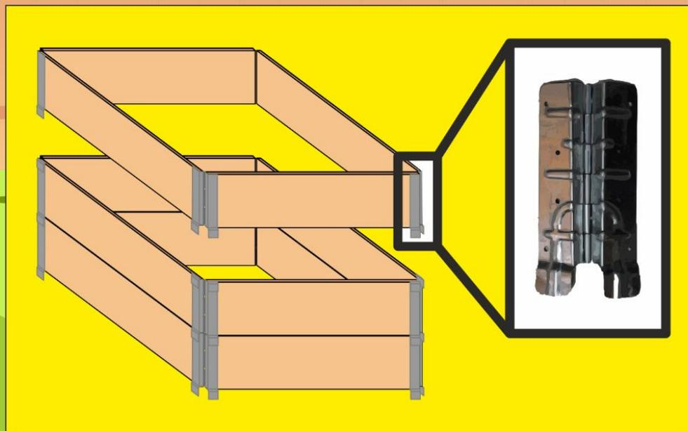
*Первая секция устанавливается на землю и углубляется в неё выступами петель, на этом этапе необходимо чтобы каждый угол грядки был равен 90°. Последующие секции устанавливаются поверх предыдущих, соединение происходит за счет выступов петель. Дополнительные инструменты для установки высоких грядок не понадобятся.*
