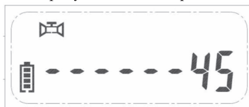
Рис. 7.16 — Режим «Таймер процедуры контроля протечки»
