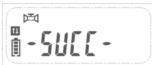
Рис. 7.15 — Режим «Успешная передача данных»
