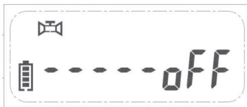
Рис. 7.17 — Режим «Завершение процедуры контроля протечки»
