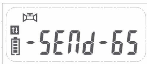
Рис. 7.12 — Режим «Мощность сигнала GPRS»
