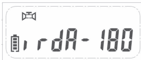
Рис. 7.13 — Режим «Активация ИК-порта и таймер»
