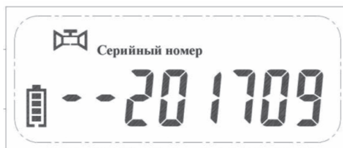
Рис. 7.7 — Режим «Серийный номер» (первые 6 цифр)
