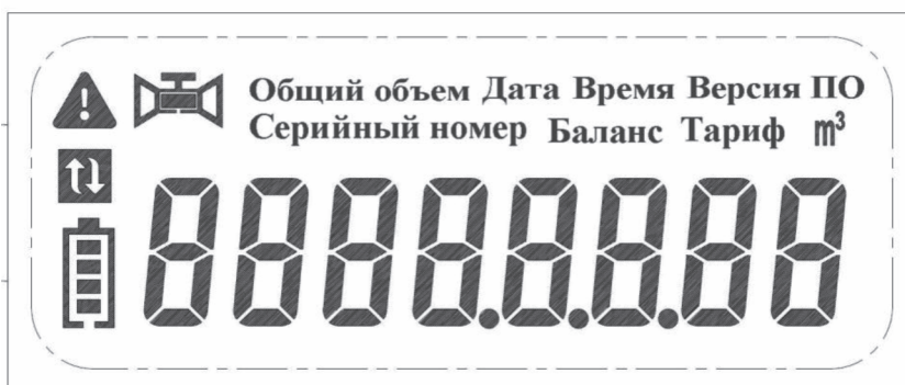
Рис. 7.1 — Элементы индикации дисплея
