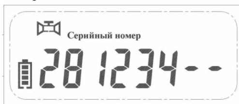
Рис. 7.8 — Режим «Серийный номер» (последние 6 цифр)
