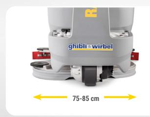
Две полосы для очистки благодаря двухщёточному узлу 75 и 85 см для адаптации к любым типам помещений, от небольших, средних и до самых загруженных площадей.
