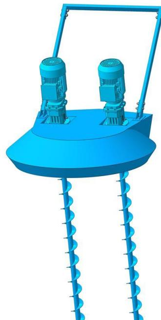
горизонтально расположить ворошитель на зерновой насыпи. Выбрать длину шнека таким образом, чтобы он в вертикальном положении не мог соприкоснуться с полом. Включить ворошитель, стоя со стороны двигателя. После включения двигателя шнек внедрится в зерно. Когда шнек займет вертикальное положение, ворошитель начнет передвигаться и перерабатывать зерновую насыпь.
