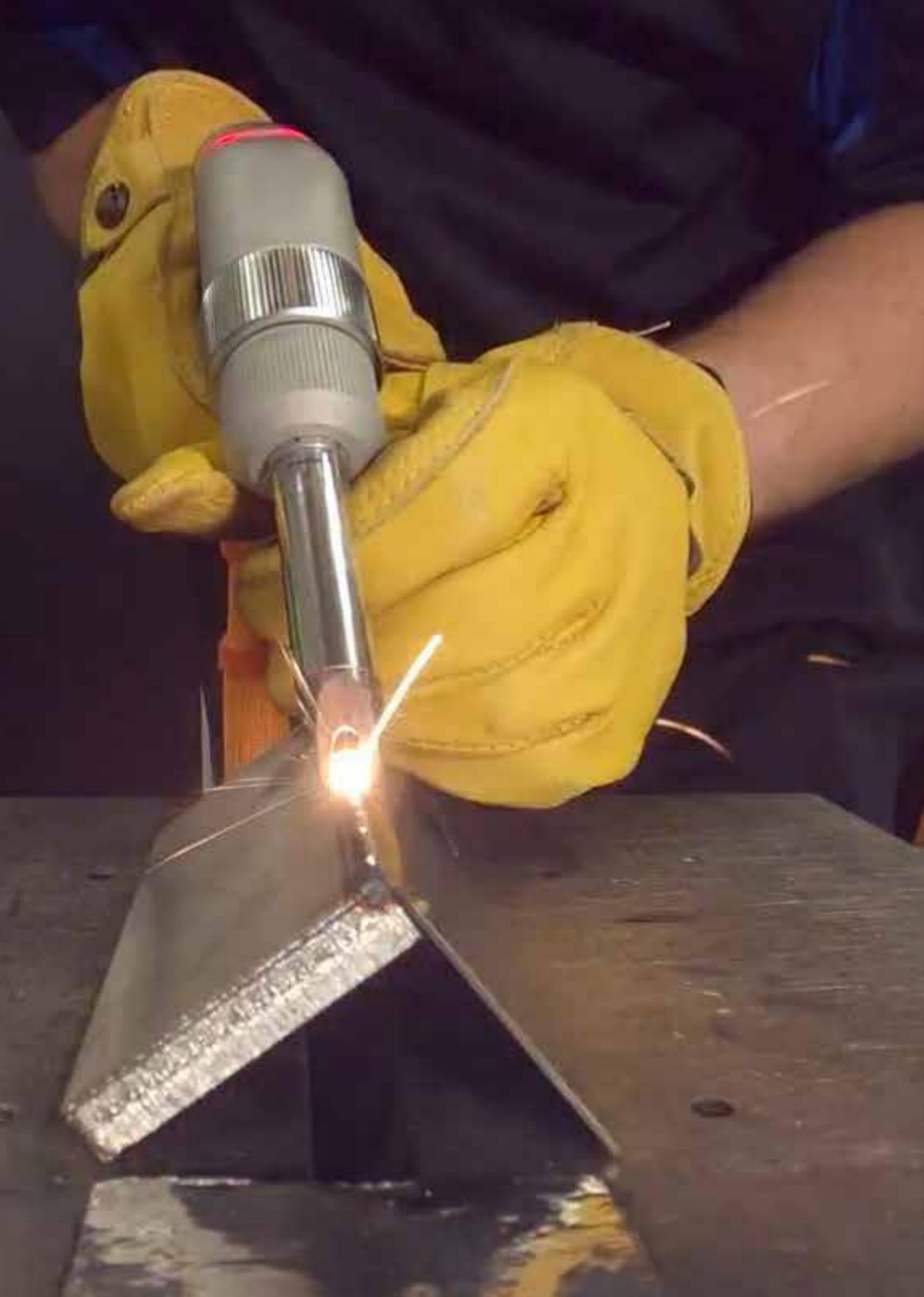
Ручной лазерный сварочный
