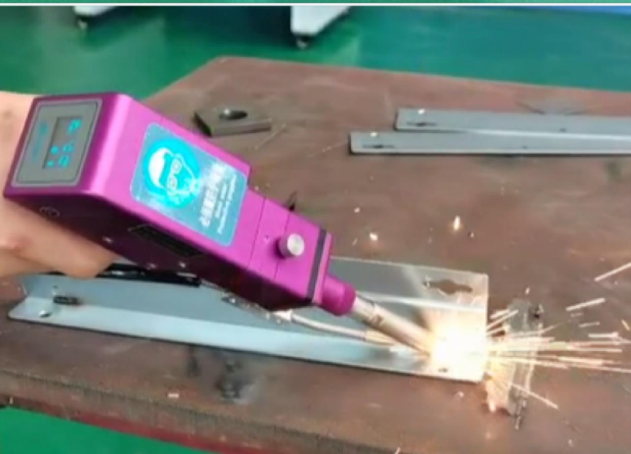
Двойная осциллирующая сварочная головка Kirin с автоматической подачей проволоки способна выполнять сварку в различных световых режимах, таких как точечный, линейный, круговой, кольцевой и восьмигранный.
