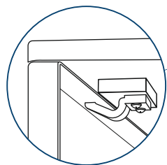
УЛУЧШЕННЫЙ ВАРИАНТ КРЕПЛЕНИЯ ЭКРАНА К БОРТАМ ВАННЫ
