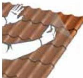
Не допускается эксплуатация изделий с защитной плёнкой после монтажа. Пленка снимается в процессе монтажа во избежание её "прикипания" к покрытию.
