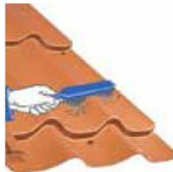
Стружки, образовавшиеся при вкручивании саморезов, необходимо смести с поверхности щеткой, иначе они заржавеют и могут испортить покрытие
