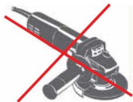
Категорически запрещено использовать углошлифовальную машинку с абразивным кругом ("болгарку"), т.к. выжигается не только полимерное покрытие, но и цинк.
