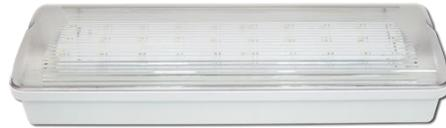
Ток потребления: 4 ВА, варианты питания 220 В, степень защиты IP 65, габаритные размеры 350x105x72 мм, масса 0.61 кг. Количество светодиодов: 30 шт. Источник питания Ni-Cd аккумулятор 3 x AA 1,2 В 1000 мАч. Время автономной работы – 3 часа.
