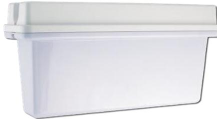
Ток потребления: 8 ВА, варианты питания 220 В, степень защиты IP 65, габаритные размеры 350x175x105 мм, масса 0,71 кг. Количество светодиодов: 30 шт. Источник питания Ni-Cd аккумулятор 3 x AA 1,2 В 1000 мАч. Время автономной работы – 3 часа.
