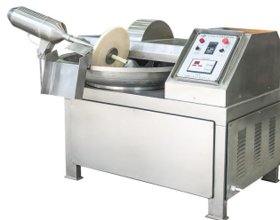
斩拌机 измельчительная машина
