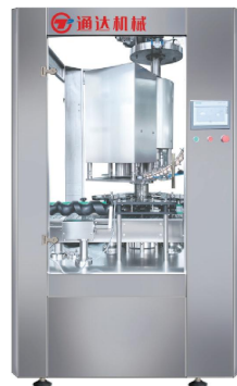
打塞机 укупорочная машина
