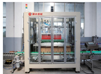
自动装箱机 автоматическая упаковочная машина,
