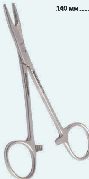
HEGAR-OLSEN Иглодержатель с ножницами, прямой, бранши с продольным желобом, насечка 0,4 мм, для нитей 4/0-6/0
